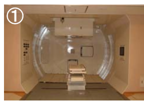
粒子線治療室 陽子線照射装置が360度回転し、ひとりひとりの患者さんに最適な角度から陽子線を照射できる。
